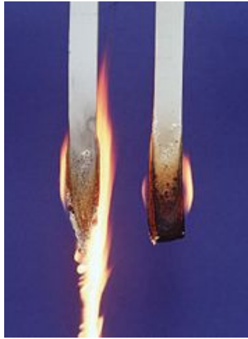
Yanmazlık testi: Saf termoplastik malzeme (solda), NMT-Kil 1000 serisi organomodifiye nanokil içeren termoplastik malzeme (sağda)
